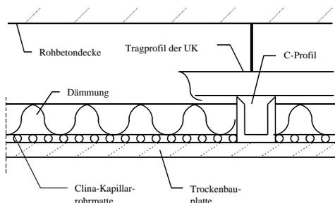
Zwischen den Profilen der Unterkonstruktion einer geschlossenen Trockenbaudecke werden die *Clina*-Kapillarrohrmatten unterhalb eines quer gespannten Gittergewebes, welches mit Dämmung abgedeckt ist, fixiert. Dadurch können beim Anschrauben der Trockenbauplatte die Kapillarrohre nicht nach oben ausweichen, und deren flächiges Anliegen ist gewährleistet.
