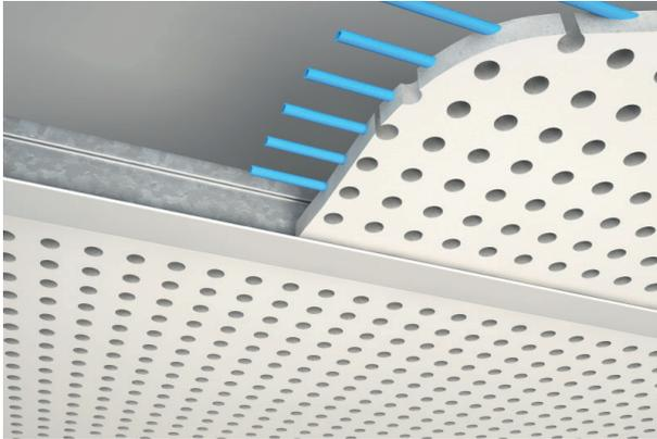
Die vorgefertigten Gipskartonkassetten werden in handelsübliche T-Schienen T15/T24 eingelegt. **Wichtig**, beim Einlegen der Kassetten Stoffhandschuhe tragen, da die Oberfläche werkseitig weiß beschichtet ist. Die Kassetten sind reversibel.
