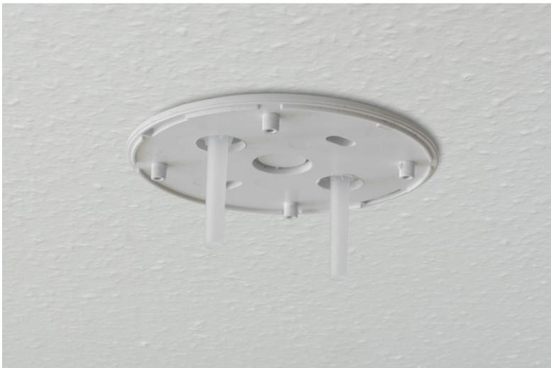
Zunächst die „Fühlerröhrchen“ des Taupunktfühlers durch die beiden großen Öffnungen in der Grundplatte führen. Die glatte Seite der Grundplatte zeigt dabei zur Decke.
